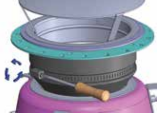
Şekil 12c3 Boğaz lastiği üzerindeki kelepçeyi gevşetiniz.
